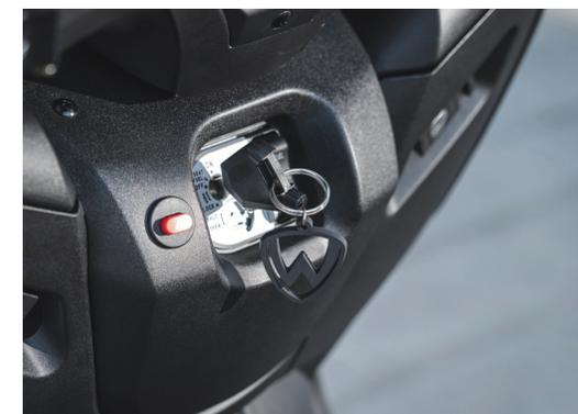
■ Cerradura con sistema de seguridad y botón para la apertura de la tapa del depósito de combustible y del asiento
